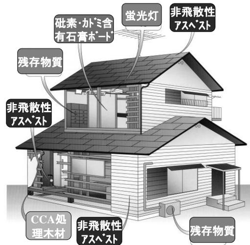
図8-7 木造建築物の解体時に注意が必要な有害物<sup>6)</sup>
