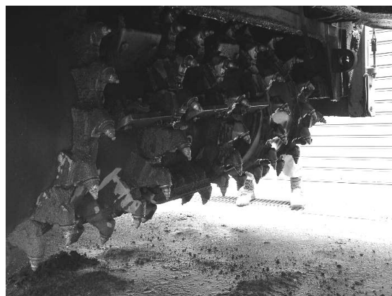
図5-4 路面切削機の回転ドラムとビット
