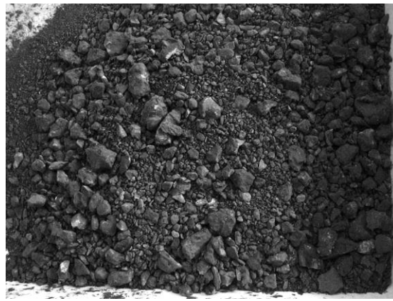
写真5-6 路面切削機で削り取られたアスファルト塊（切削材）
